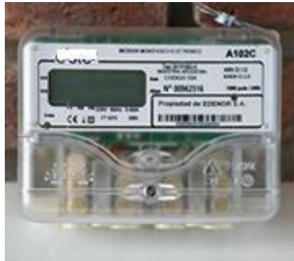
Figura 11. Modelo de medidor de energía eléctrica apto para módulo adquisidor de datos
