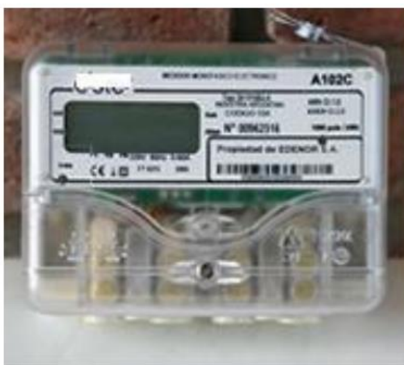
Figura 6 - Modelo de medidor de energía eléctrica apto para módulo adquisidor de datos
